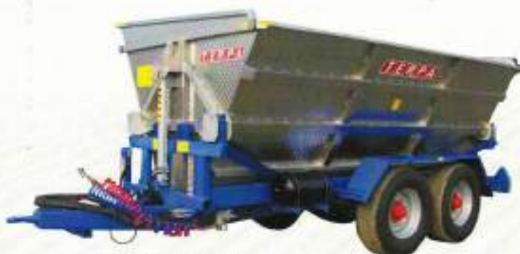
TL 12 P bilaterale Assale posteriore autosterzante Sospensioni con quattro balestre paraboliche
