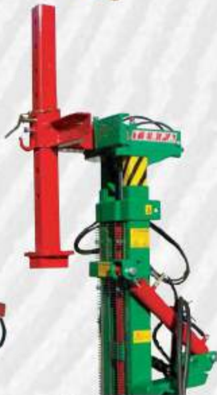
Traslatore superiore idraulico con pinza cavapali.
